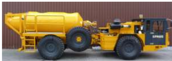
Машины для перевозки бетонной смеси
