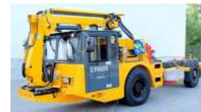
Машины со стрелой для механизированного заряжения шпуров и скважин (для навесного эмульсионного оборудования)
